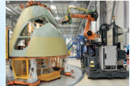
AEROLIA Assemblage robotisé d'un cockpit Airbus A320
